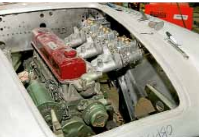
Drivlina, chassi och kaross provmonteras före lackering för att kunna passas ihop ordentligt.
